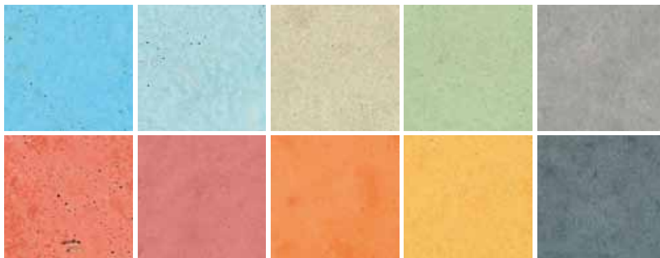
Abb. 38 Farbbeton mit unterschiedlichen Pigmenten.
