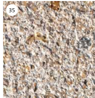
Abb. 34 Sichtbarwerden der Gesteinskörner durch Schleifen der Oberfläche.
