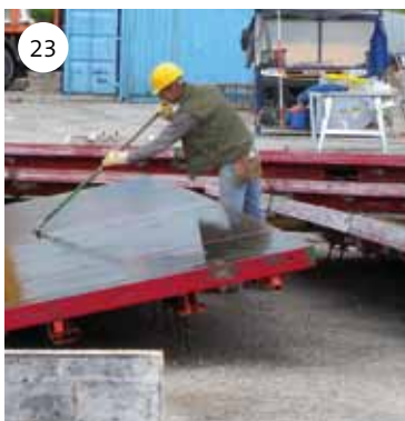
Abb. 25 Auftragen des Trennmittels mit der Spritzdüse.
