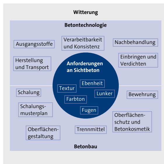
Abb. 1 Schematische Darstellung zu Anforderungen an Sichtbeton und Einflussfaktoren aus Betontechnologie und Betonbau sowie durch Witterung.
